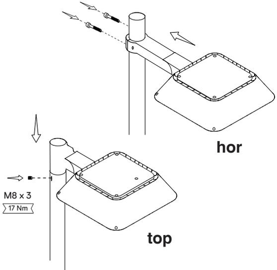
Colocar la luminaria a la columna según modelo; top (terminal Ø60) o lat (conector ajustable) y fijar mediante los esparragos o tornillos según modelo.
