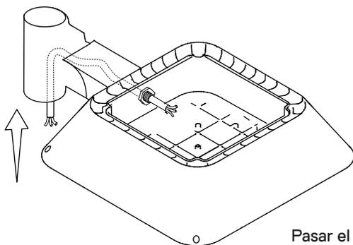
Pasar el cable de conexión eléctrica por el interior del terminal y pasarlo a través de la cúpula.
