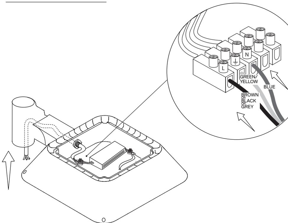
Hacer la conexión entre el cable de conexión eléctrica y la electrónica siguiendo el criterio de colores.
