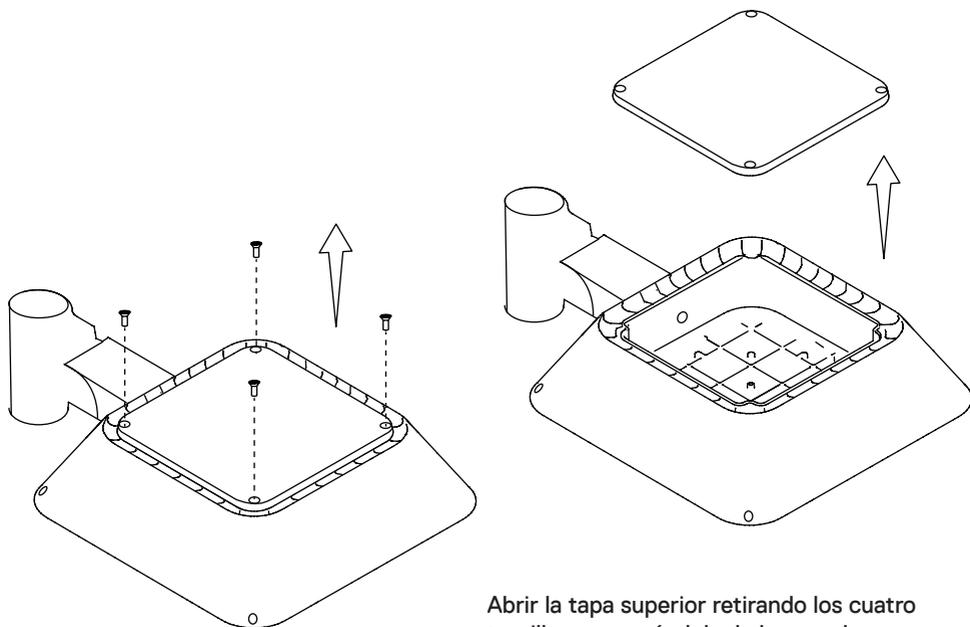
Abrire la tapa superior retirando los cuatro tornillos y separándola de la armadura.
