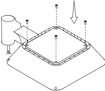
Volver a colocar la tapa de la luminaria y apretar los tornillos.
